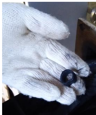
処理後の状態 (水分が完全に飛んでおり、バルサ材のように軽くなった)
