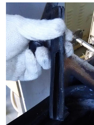
処理後の状態 (水分が完全に飛んでおり、バルサ材のように軽くなった)
